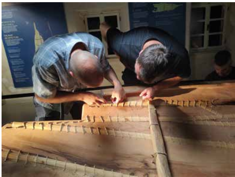
Slika 4. Replika broda Zambratija – uzdužno šivanje oplata
