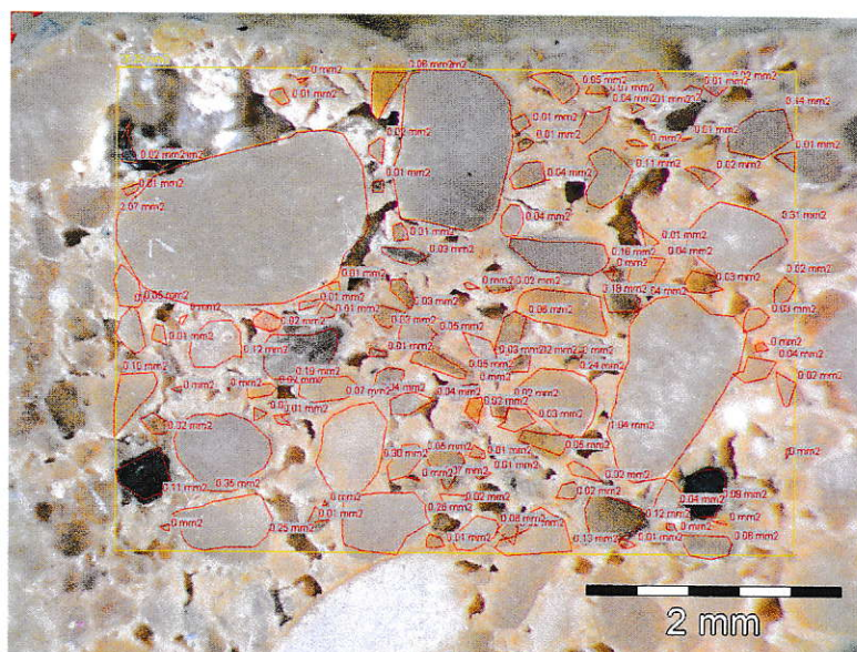
Slika 13. Mikrofotografija poprečnog presjeka uzorka žbuke lab broj 19767 s mjerama veličine zrna
