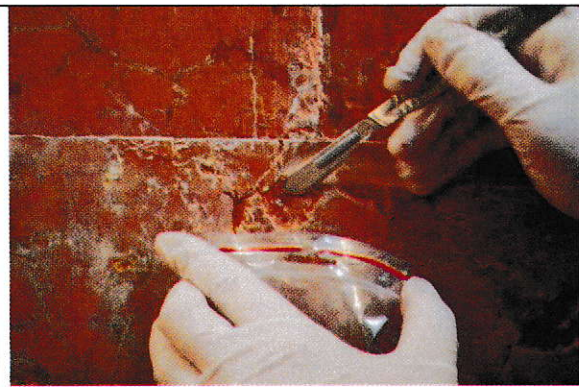
Sl. 36 Uzorkovanje praškastog osipavanja sa mramora Rosso Verona na sjevernom zidu
