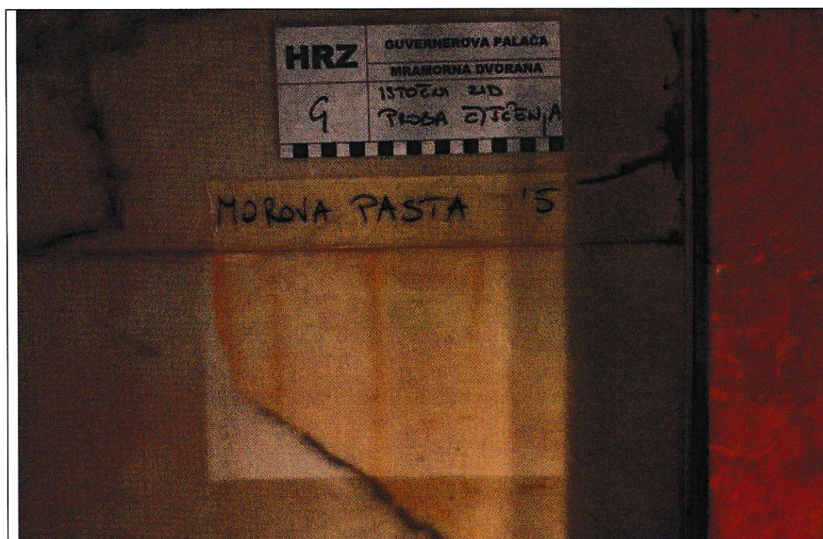
Sl. 56 Stanje nakon čišćenja Morovom pastom kroz 5 minuta
