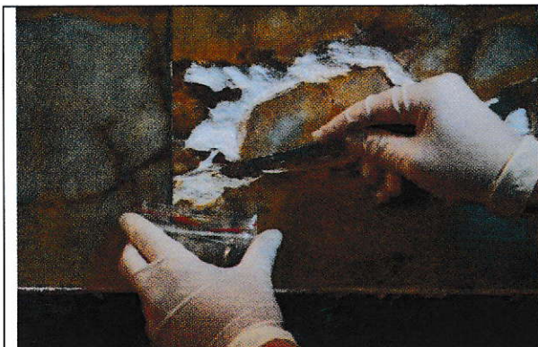
Sl. 35 Uzorkovanje soli sa mramora Giallo Siena na sjevernom zidu
